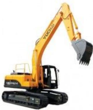
Гидравлический гусеничный экскаватор Yuchai YC210LC-8 оснащен мощным качественным двигателем CUMMINS. Применяется для требовательных условий работы, для строительства дорог, котлованов или подготовки лесных и аграрных площадей. Гидравлика Nachi/Husco и тихая ROPS кабина гарантируют беспроблемную работу.
